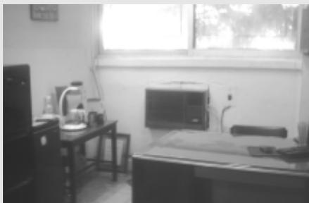
En la imagen anterior, el equipo trabaja de manera ineficaz porque se encuentra mal ubicado. Además, está seleccionado a una temperatura fuera de confort. Se encuentran aparatos eléctricos que emiten calor como la cafetera y el refrigerador. De esta manera el equipo pierde eficiencia y, por tanto, incrementa su consumo.
