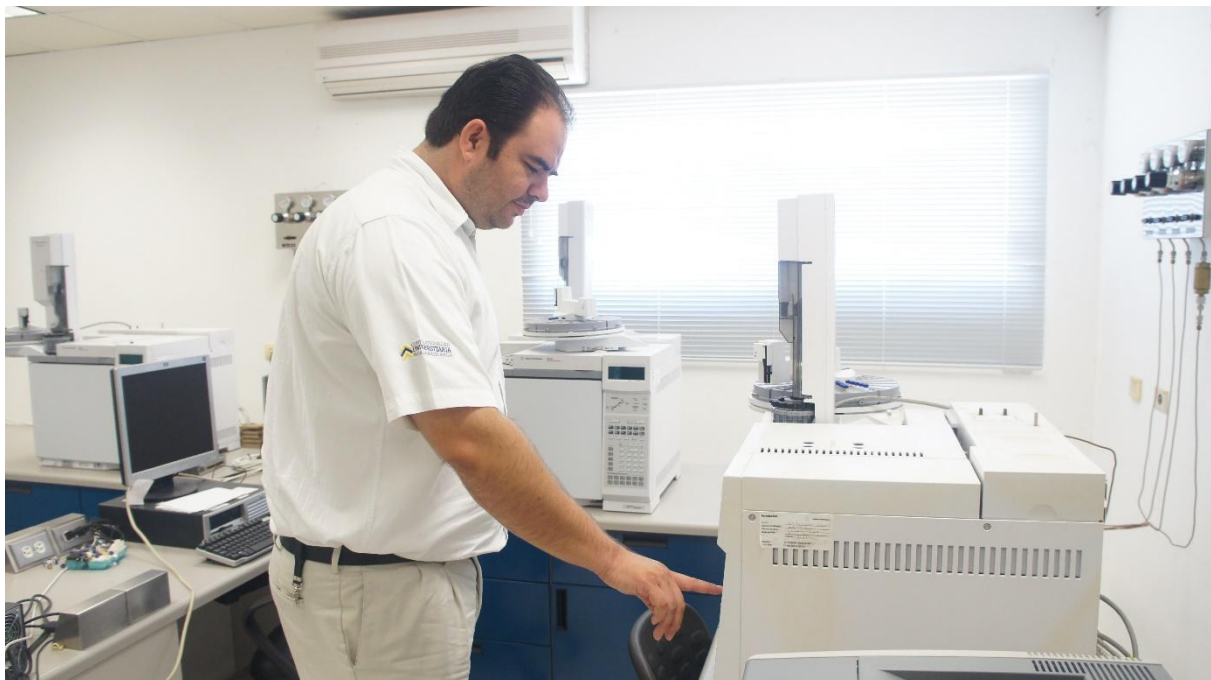
Cromatógrafo de Gases acoplada a espectrómetro de Masas, Agilent Technologies
