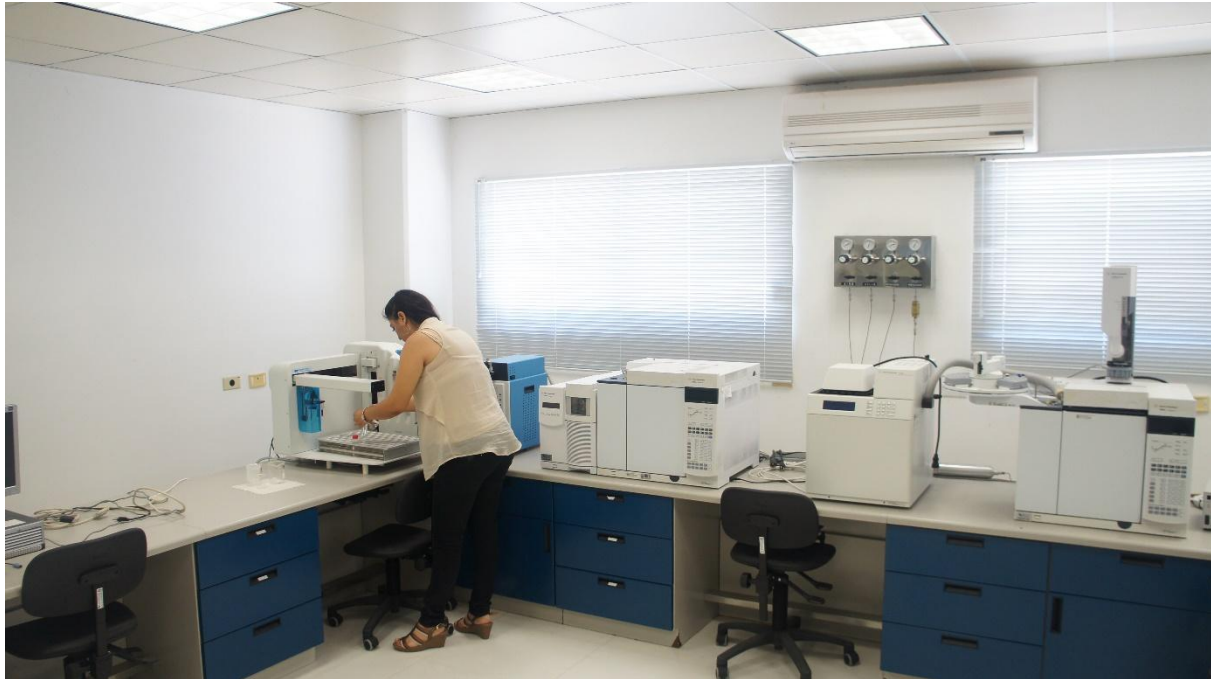
Cromatógrafo de gases acoplado a espectrómetro de masas con automuestreador y concentrador, Agilent Technologies
