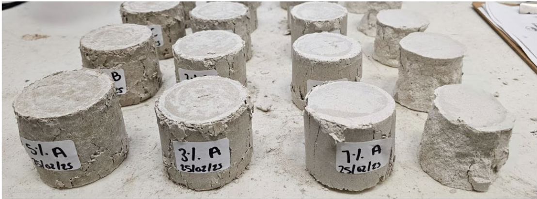
Figura 5. Fotografía de las muestras y sus réplicas después del ensayo de resistencia a la compresión.
